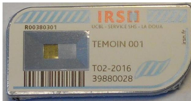
Modèle de dosimètre passif
